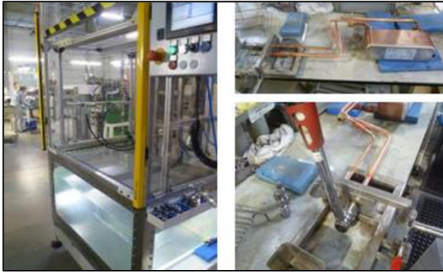
Obrázok 23: Skúška únikov PHE (Zdroj: Vlastné spracovanie)
