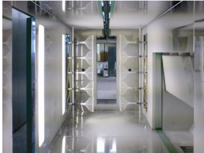
Obrázek č. 4 Mechanizované stříkací tribo pracoviště kde upravované zboží je zavěšeno na průběžném dopravníku. [JEŽEK, 2012]
