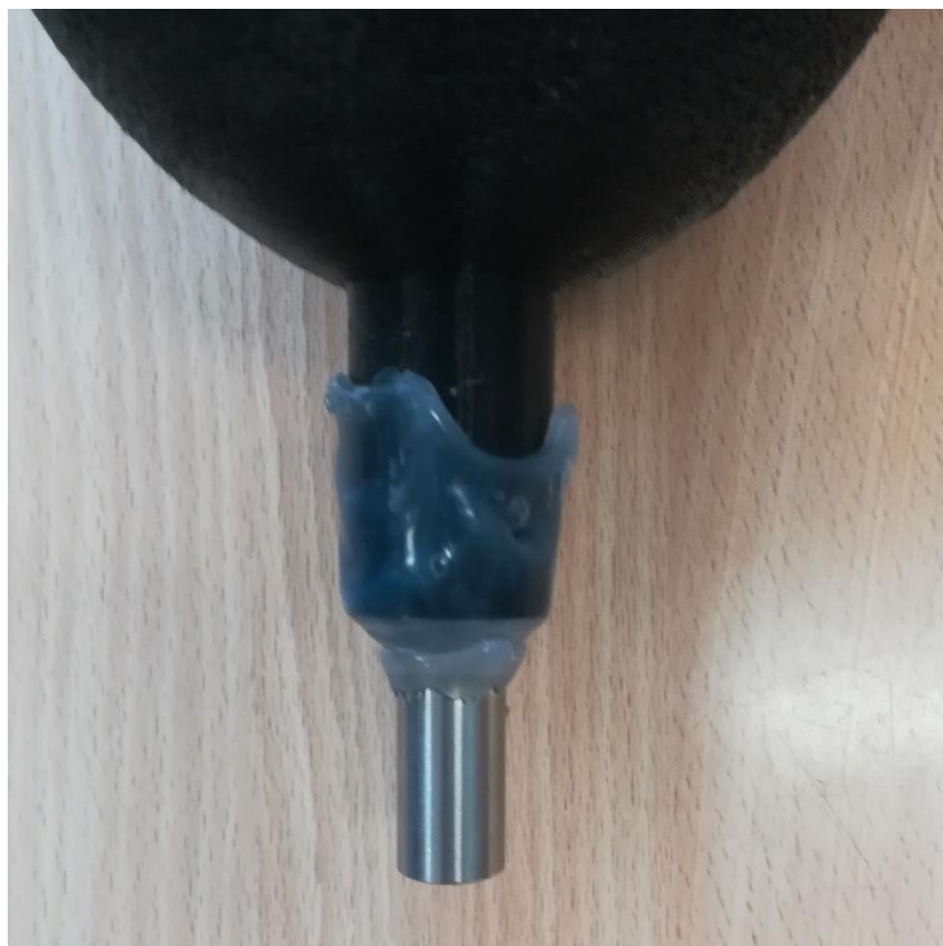
Obrázek 23: Kovový nástavec utěsněný silikonem
