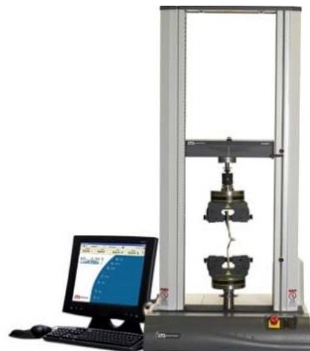
Obr. 5: Univerzální zkušební zařízení INSTRON (Instron)
