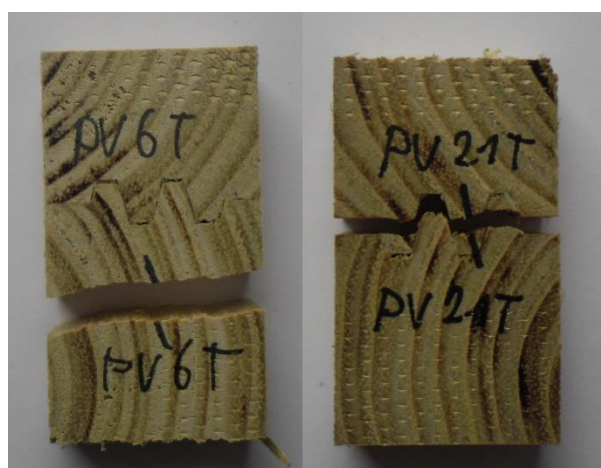
Obr. 24: Porušení vzorku ve dřevě (vlevo) a v lepené spáře (vpravo) – PVAc, ozub (Stehlík)
