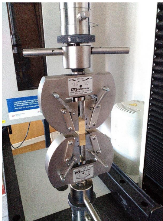
Obr. 6: Upnutí vzorku v čelistech zkušebního stroje (Stehlík)
