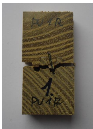
Obr. 25: Porušení vzorku v lepené spáře – PUR, ozub (Stehlík)
