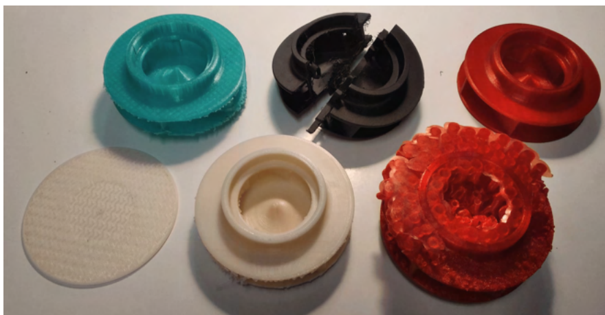
Obrázek 4.1: Nepovedené výtisky oběžného kola
