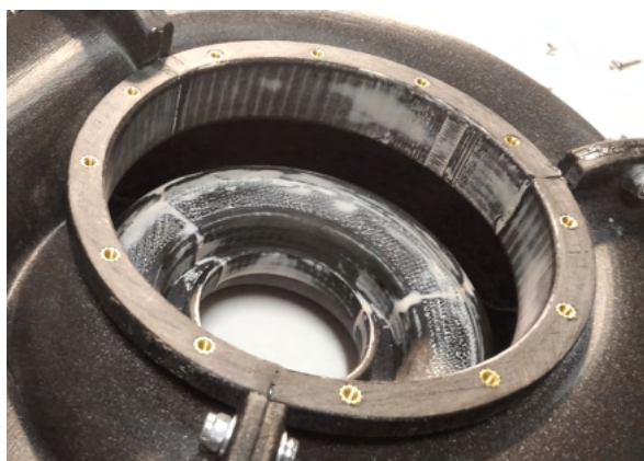
Obrázek 4.15: Detail závitových vložek pro montáž motorového lože
