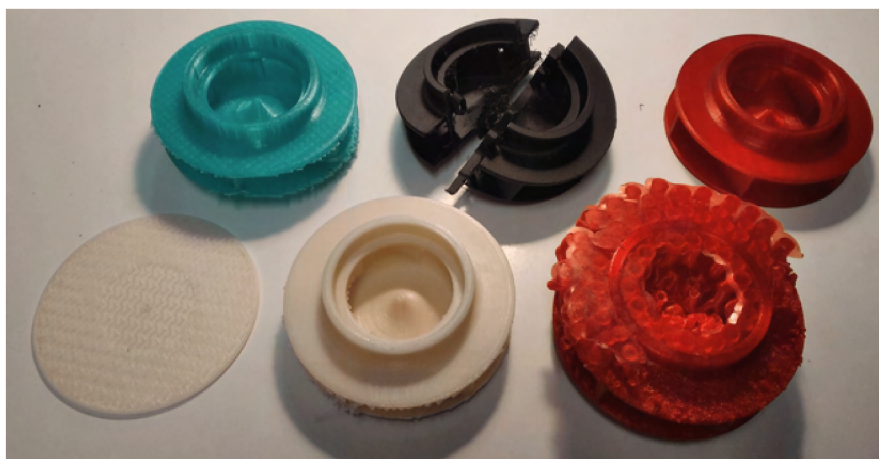
Obrázek 4.1: Nepovedené výtisky oběžného kola
