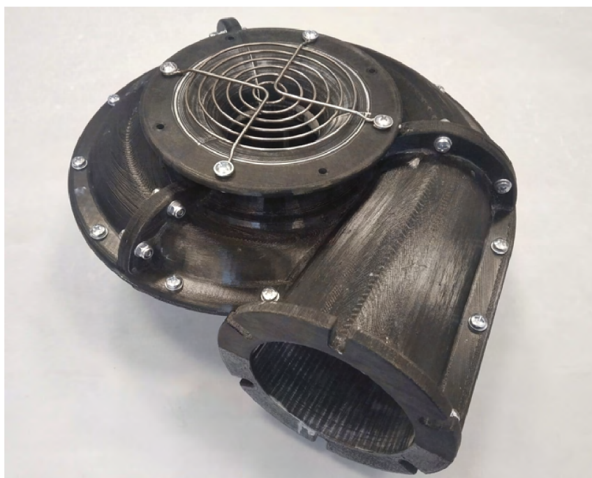
Obrázek 4.17: Sestavená spirální skříně podle návrhu B2
