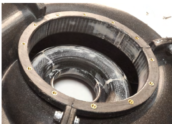
Obrázek 4.15: Detail závitových vložek pro montáž motorového lože
