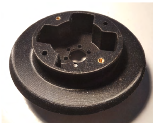
Obrázek 4.7: Motorové lože (strana s umístěním pro motor)
