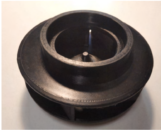
Obrázek 4.2: Oběžné kolo podle návrhu B (vstupní strana)
