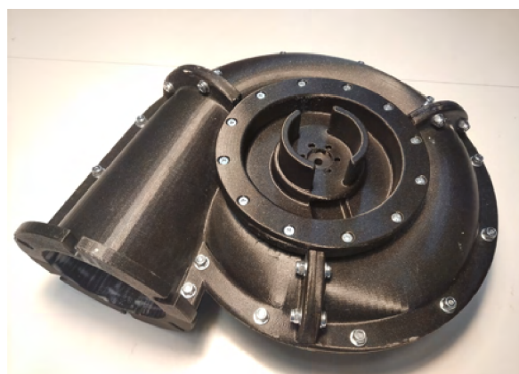
Obrázek 4.16: Sestavená spirální skříně podle návrhu B2 zezadu
