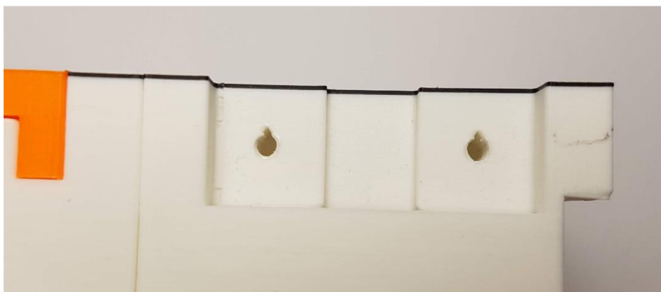
Obr. 17: Detail děr se špičkou pro zařezání šroubu.
