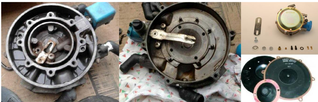
Obr. 3 Podtlakový reduktor LOVATO a) malá komora, b) veľká komora, c) sada membrán [2]
