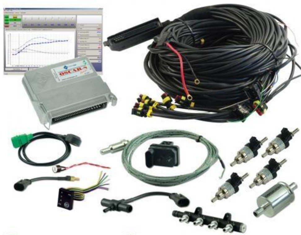
Obr. 20 Elektronika sekvenčného vstrekovania LPG [15]
