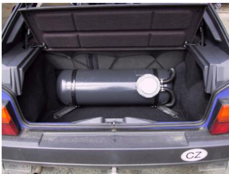
Obr. 7 Typické umiestnenie valcovej nádrže, škoda Favorit [14]
