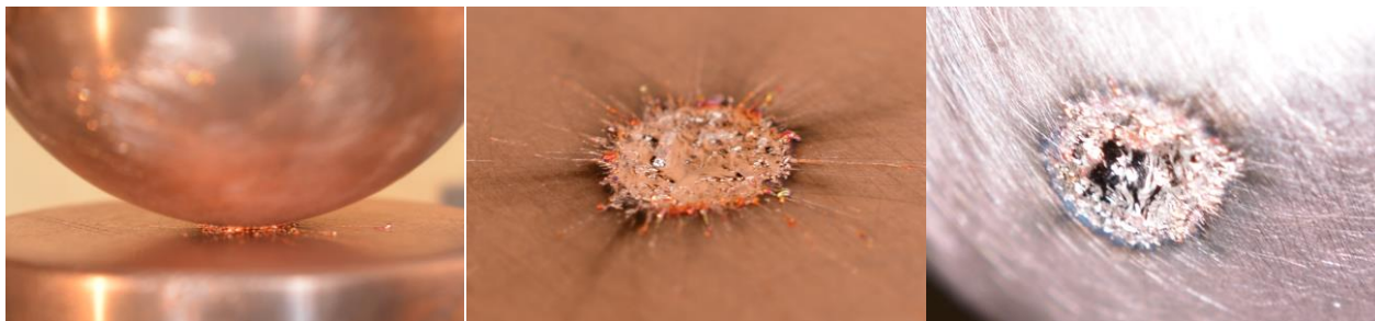
Obr. 5.22 Svaření kontaktů při pokusu č. 9 a) detail svaru b) místo svaru pevného kontaktu c) místo svaru pohyblivého kontaktu
