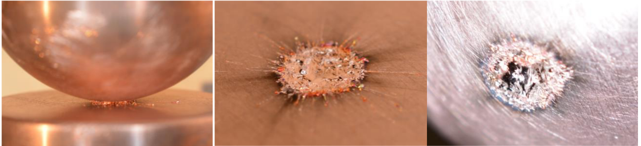
Obr. 5.22 Svaření kontaktů při pokusu č. 9 a) detail svaru b) místo svaru pevného kontaktu c) místo svaru pohyblivého kontaktu
