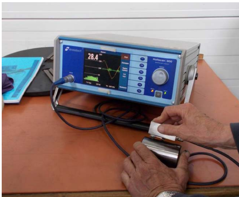
Obr. 3.28 Přístroj pro měření Barkhausenova šumu Rollscan 300.
