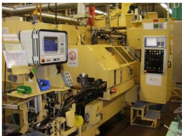
Obr. 2.12 Bruska pro broušení otvorů typu NOVA 2GR 10/65 [26, 27].
