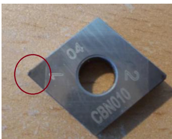
Obr. 3.20 VBD CNGA 120404 S01020 L1B CBN010 před provedením experimentu.
