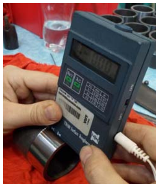
Obr. 3.14 Ruční drsnoměr TS100.
