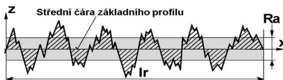
Obr. 3.8 Profil obrobeneé plochy se znázorněním Ra [31].
