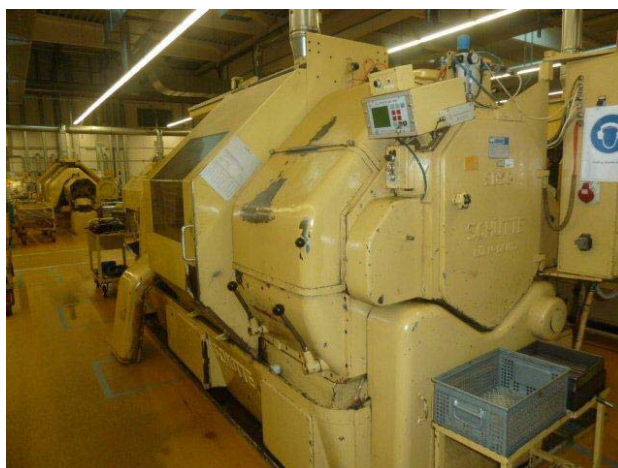
Obr. 2.3 Soustružnický automat SCHÜTTE SD [2, 26].
