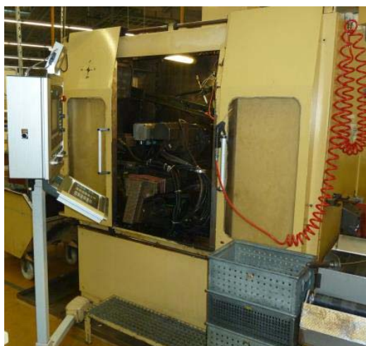
Obr. 2.7 Dokončovací CNC soustruh EDM 101 CNC [2, 26].
