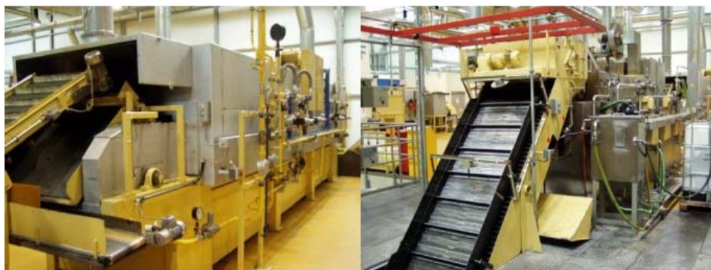
Obr. 2.11 Kalicí a popouštěcí linka od firmy AICHELIN [26, 27].
