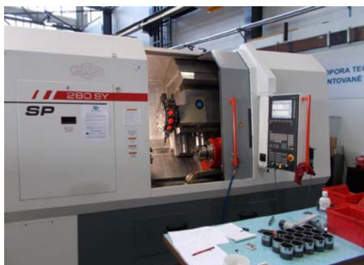
Obr. 3.11 CNC soustruh SP 280 SY.
