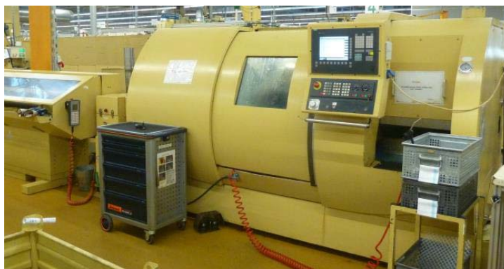
Obr. 2.6 Soustružnické centrum TRENS SLB 500 [2, 26].
