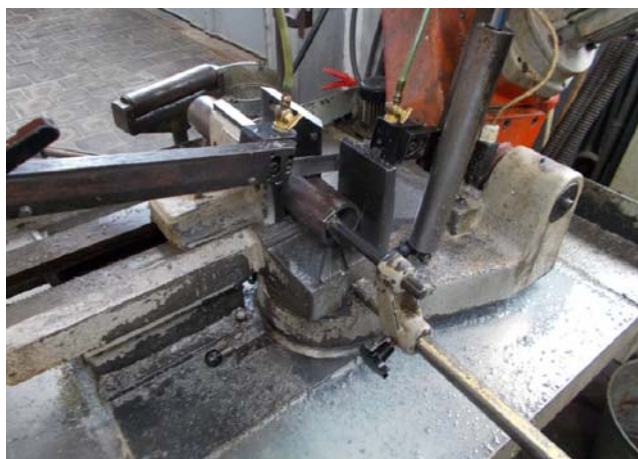
Obr. 3.4 Dělení vzorků na dílenskou pásovou pile Bomar STG220G.
