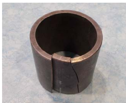
Obr. 3.13 Vyřazený vzorek číslo 1 mechanicky poškozen čelistmi sklíčidla.
