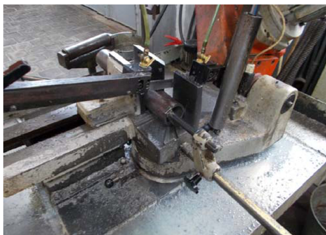
Obr. 3.4 Dělení vzorků na dílenskou pásovou pilu Bomar STG220G.
