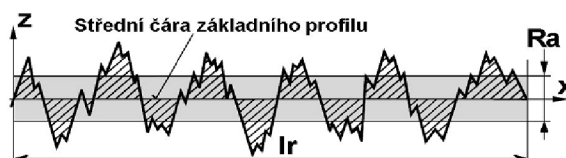
Obr. 3.8 Profil obrobenej plochy se znázorněním Ra [31].
