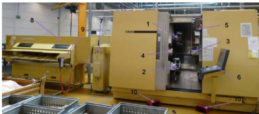
Obr. 2.4 Soustružnické centrum GILDEMEISTER TWIN [2, 26].
