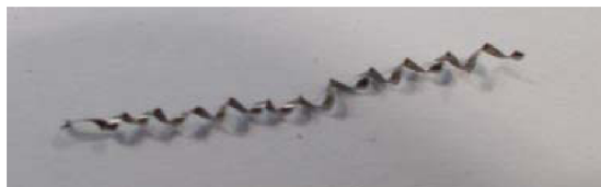
Obr. 3.16 Tříska vzniklá při obrábění vzorku číslo 2.
