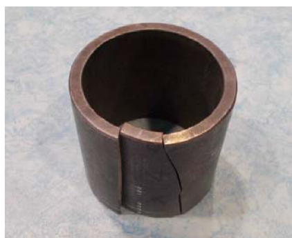
Obr. 3.13 Vyřazený vzorek číslo 1 mechanicky poškozen čelistmi sklíčidla.
