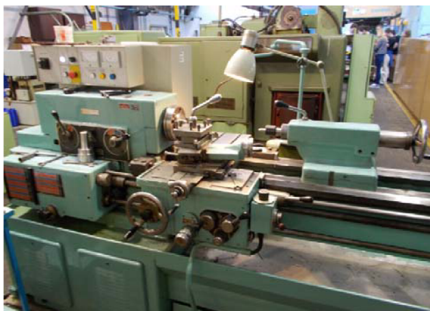
Obr. 3.5 Univerzální soustruh TOS SV18 RD.
