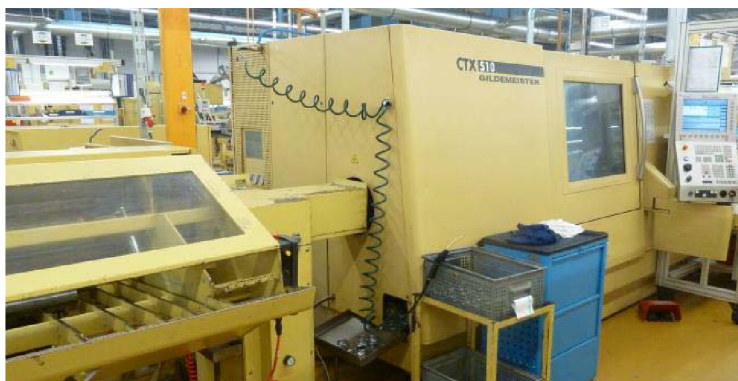
Obr. 2.5 Soustružnické centrum GILDEMEISTER CTX 510 [2, 26].
