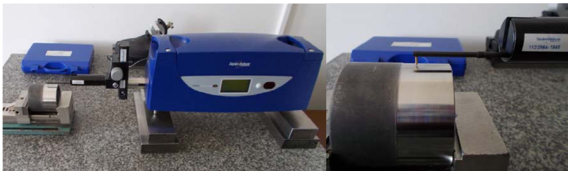
Obr. 3.15 Měření metodou TaylorHobson.
