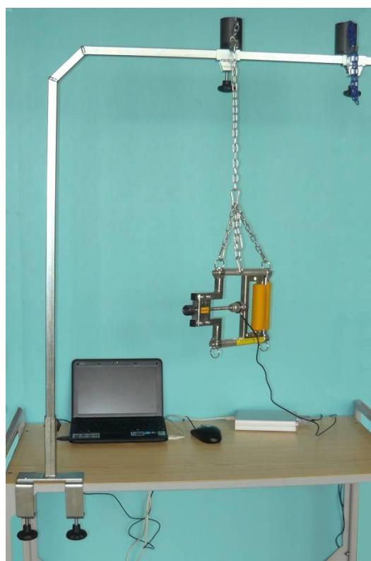
Obrázek 16. Dynamometr vyrobený katedrou biomechaniky UP v Olomouci
