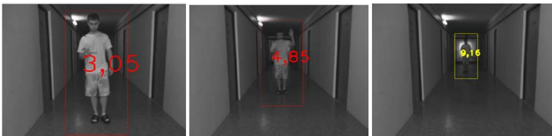
Obrázek 6.6: Po detekci je zobrazeno detekční okno a uvnitř okna pro spojené komponenty z disparitních map je vypočítaná vzdálenost: 3 m (vlevo), 5 m (na střed) a 10 m (vpravo).
