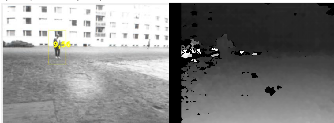
Obrázek 6.8: Detekční osoba je 14 metrů vzdálená od kamery. Na levém obraze je po detekci zobrazena její vzdálenost vypočítaná z disparitních map s metodou SGBM (vpravo).
