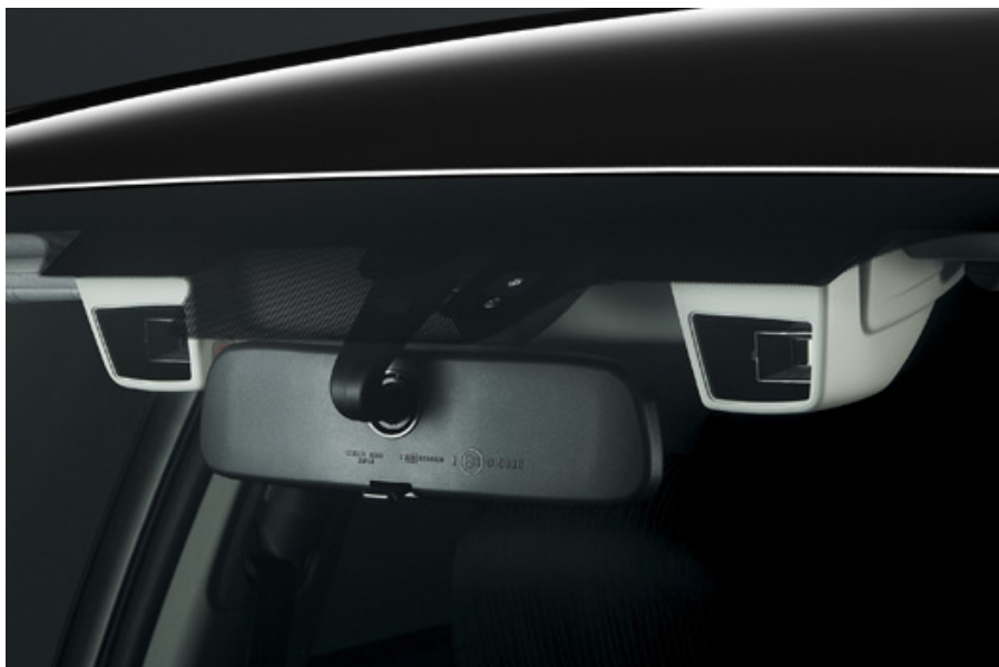
Obrázek 3.3: Systém EyeSight® používá stereo kamery namontované na čelní sklo [28].
