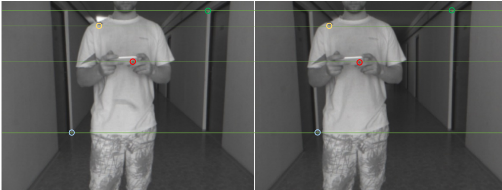
Obrázek 4.4: Po rektifikaci korespondující si body na jedné řádce
