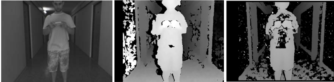
Obrázek 6.3: Z rektifikovaných obrazů (levý) je vypočítána disparitní mapa podle algoritmu Semi-Global Block Matching (střední) a Block Matching (pravý), vzdálenost objektů je 2 m.
