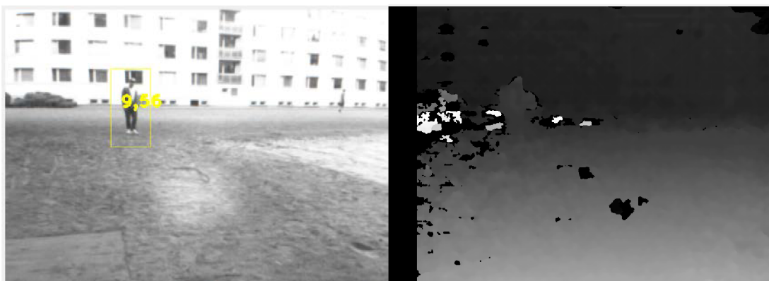
Obrázek 6.8: Detekční osoba je 14 metrů vzdálená od kamery. Na levém obrazu je po detekci zobrazena její vzdálenost vypočítaná z disparitních map s metodou SGBM (vpravo).
