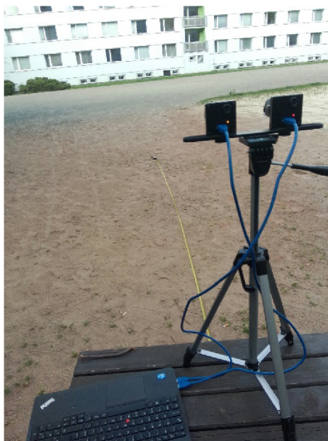
Obrázek 6.1: Použitý kamerový systém namontovaný na stativ.
