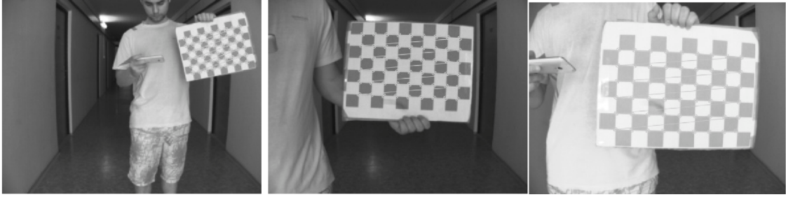
Obrázek 6.2: Funkce úspěšně rozpozná vnitřní rohy šachovnice. Rozměry jednotlivých čtverců je 38x38mm.
