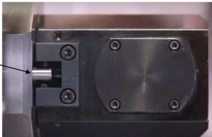
Obr. 13) VDI upínání - vyrovnání v ose Y (převzato a upraveno z [15])
