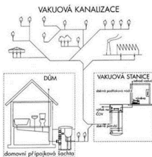
Obr. 6: Podtlaková kanalizace (Hlavínek 2001)
