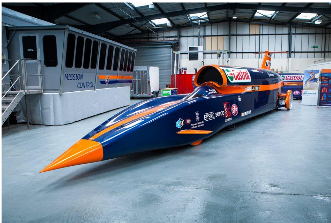
Obr. 3.9 Bloodhound SSC s hybridním motorem používající peroxid vodíku s modifikovaným palivem HTPB [27]
