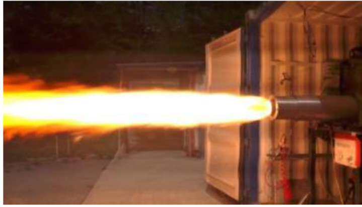
Obr. 2.5 Testování hybridního motoru s tahem 10 kN společnosti HyImpulse [11]
