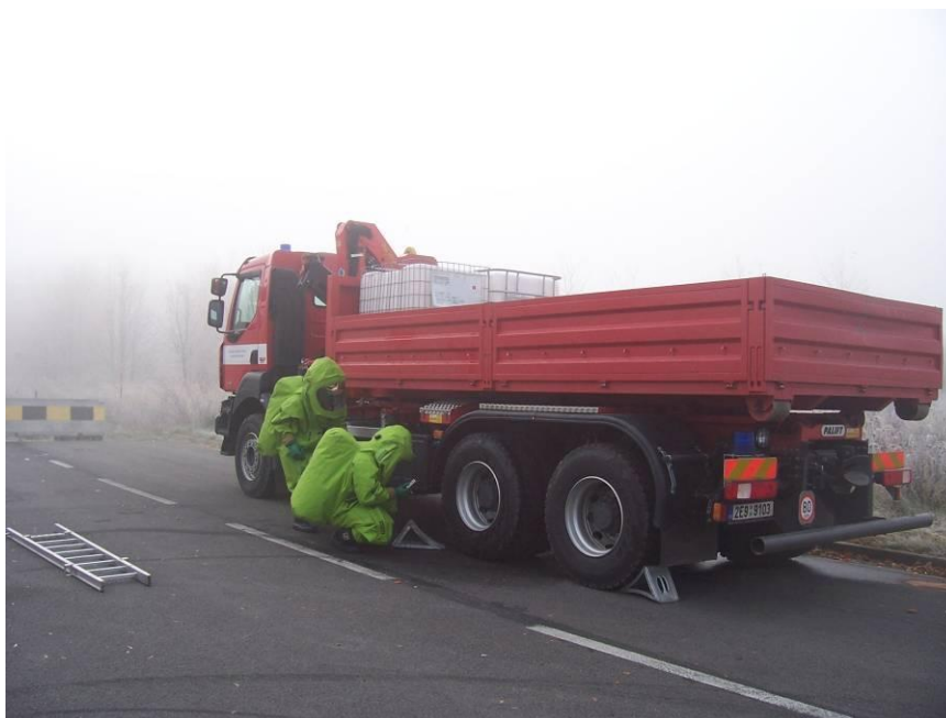
Obrázek 15 Zajištění vozidla proti pohybu (zdroj autor)
