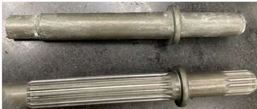
Obr. 19 Výroba drážkovaného hřídele tvářením za studena [9].
