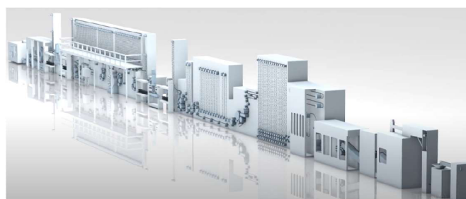
d) Výrobní linka na plechovky sprejů.
