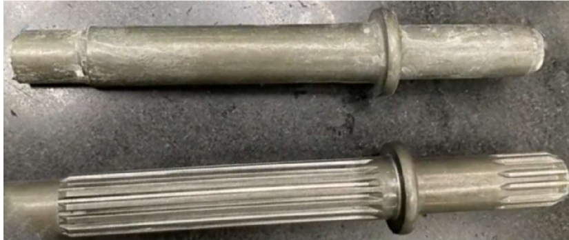
Obr. 19 Výroba drážkovaného hřídele tvářením za studena [9].
