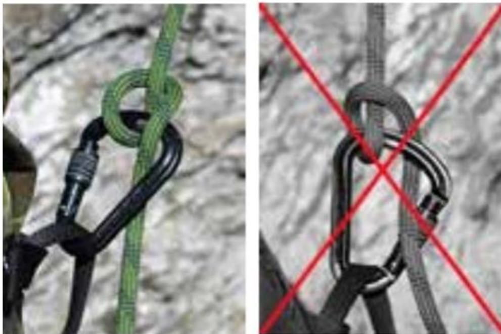
Obrázek č. 28 - Správné a nesprávné založení půllodního uzlu 45
