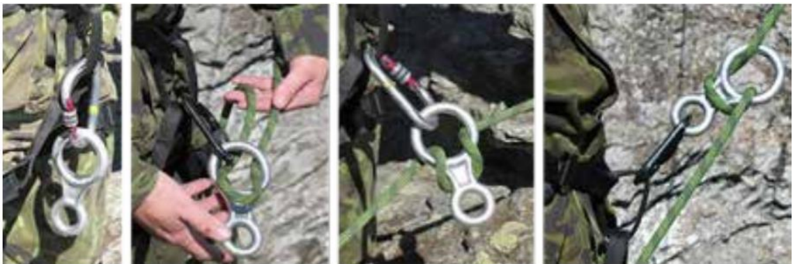
Obrázek č. 27 - Založení lana do slaňovací osmy 44
