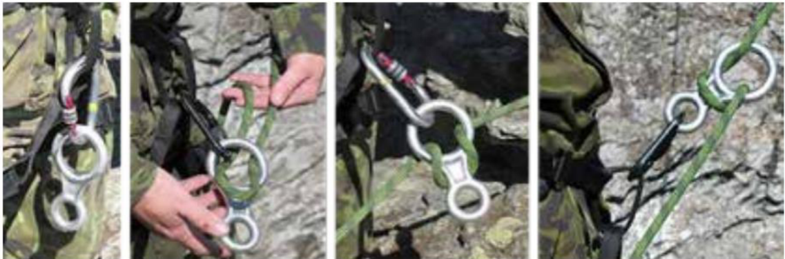
Obrázek č. 27 - Založení lana do slaňovací osmy 44
