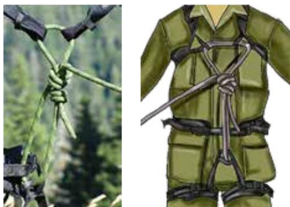
Obrázek č. 23 - Navázání přímo na lano 40
