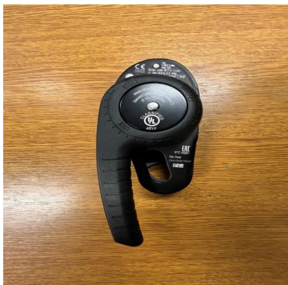
Obrázek č. 5 - Sláňovací brzda 15
