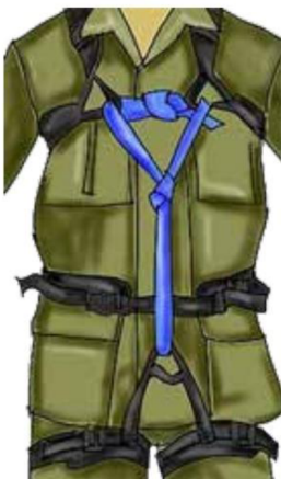
Obrázek č. 22 - Spojení sedacího a hrudního úvazu plochou smyčí 39
