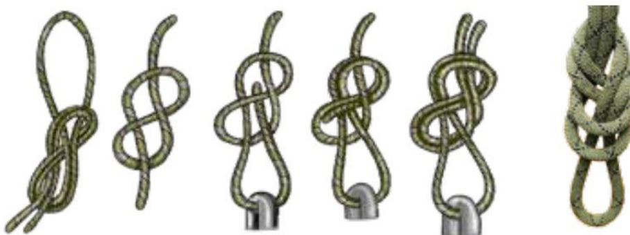
Obrázek č. 11 - Stejnoseměrný osmičkový uzel 25
