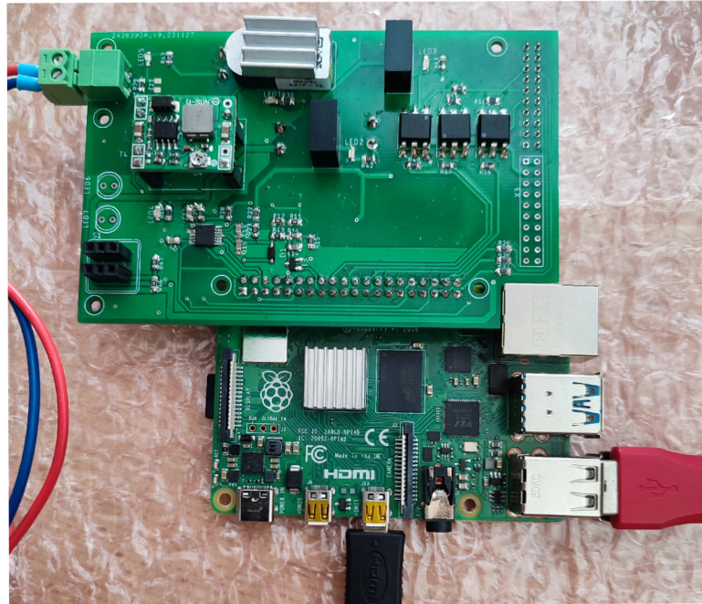
Obr. 5.5: Zapojení při ověřování funkčního AD převodníku
