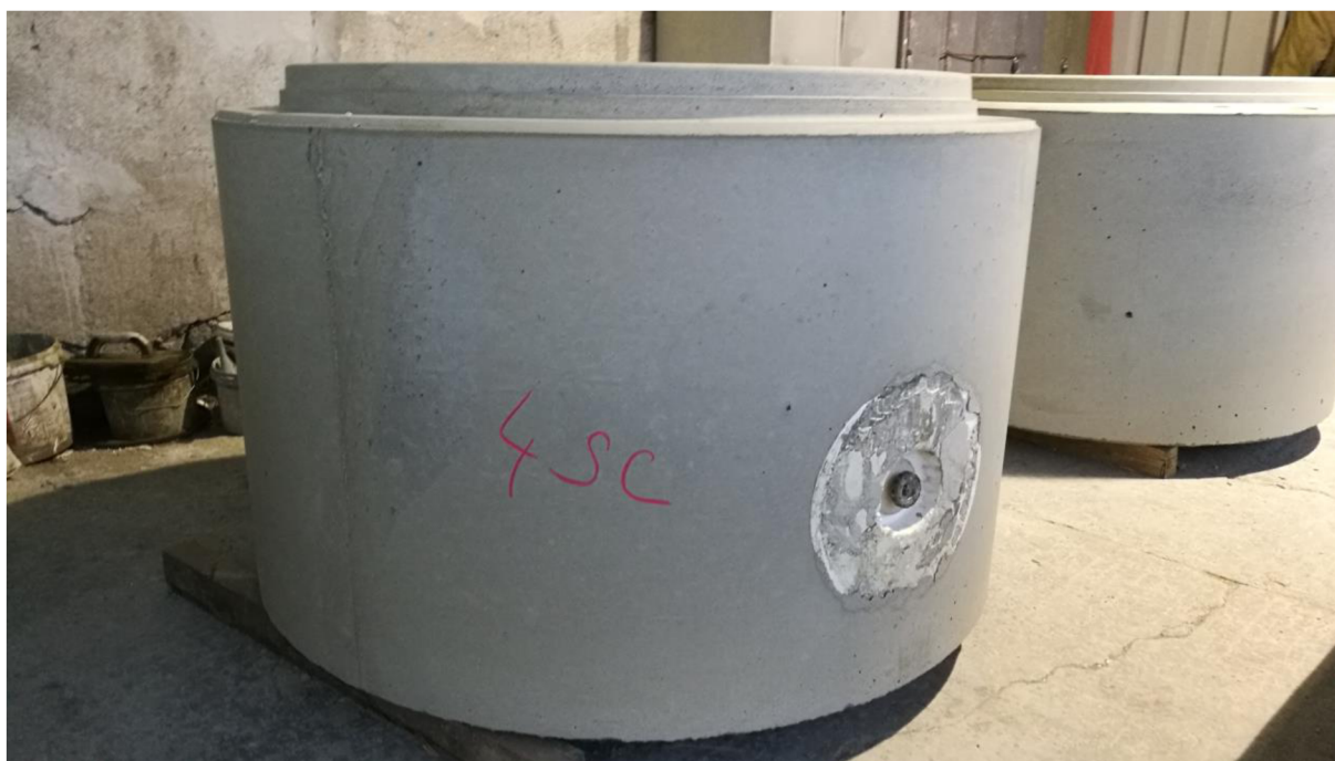
Obr. 47 – Betonový prvek odlitý z receptury s optimalizovanou křivkou zrnitosti
