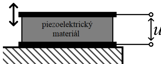
Obr. 1.2 Princip piezoelektrického snímače
