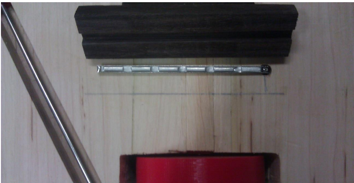
Obr. 3.6 Umístění piezoelektrického snímače
