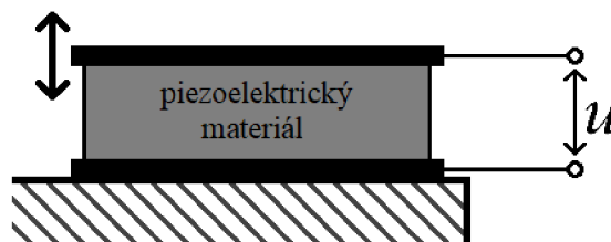
Obr. 1.2 Princip piezoelektrického snímače
