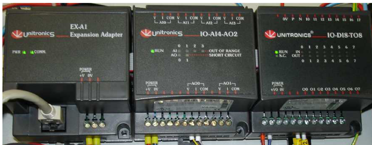
Obr. 76. Rozšíření vstupů a výstupů pomocí modulů
