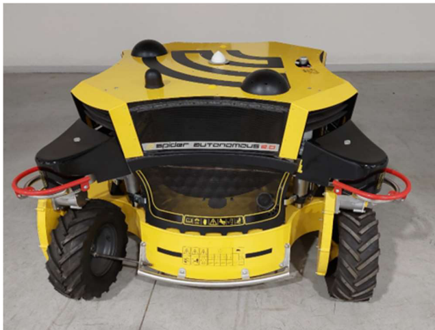
Obrázek 7 Rádiem řízený robot s rotačním ústrojím pro sečení trávníků ve svazích (foto vlastní)
