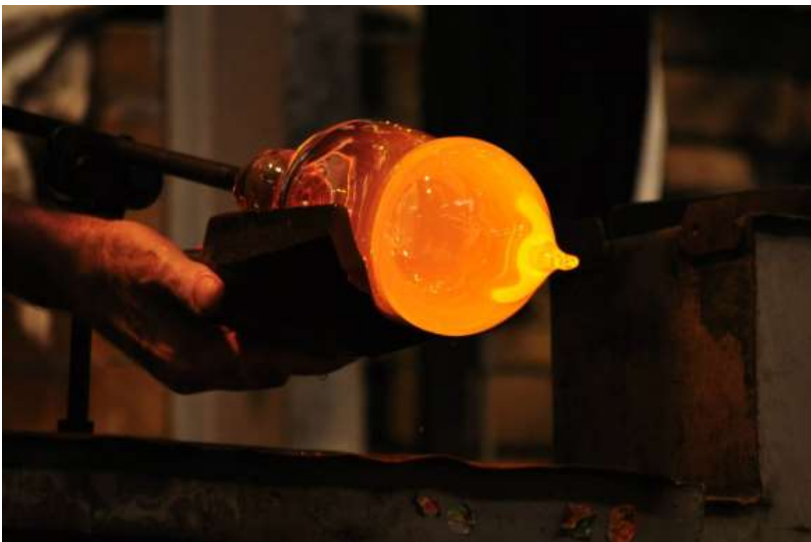
Obr. G3: Ruční výroba nápojového skla Zdroj: Interní materiál společnosti.
