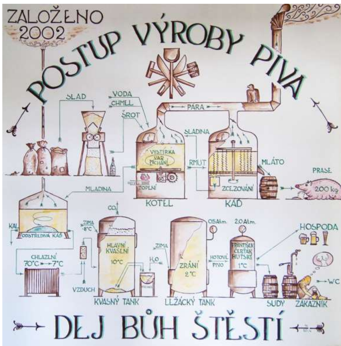
Obr. E1: Postup výroby piva
