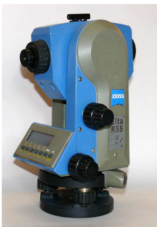
Obrázek 14 – foto - Totální stanice ZEISS ELTA R 55 [13]
