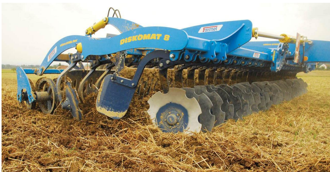
Obrázek 5. Talířový kypřič Farmet Diskomat s konstrukčním uspořádáním talířů v řadě
