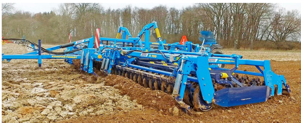
Obrázek 9. Kombinátor Farnet kompaktomat s rovnací, drobící, kypřící a utužovací sekci
