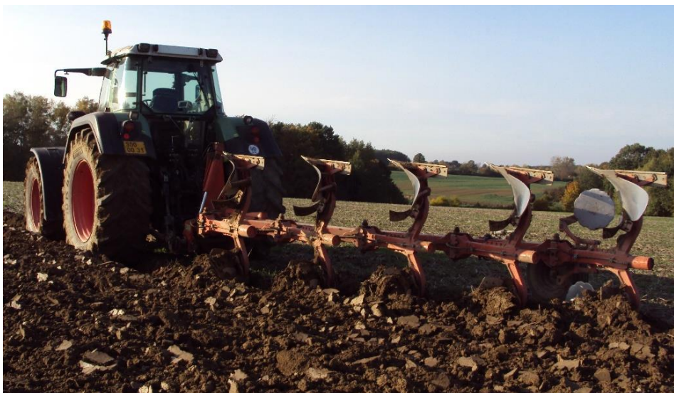
Obrázek 8. Orba oboustranným pěti-radličným pluhem Kuhn Varimaster
