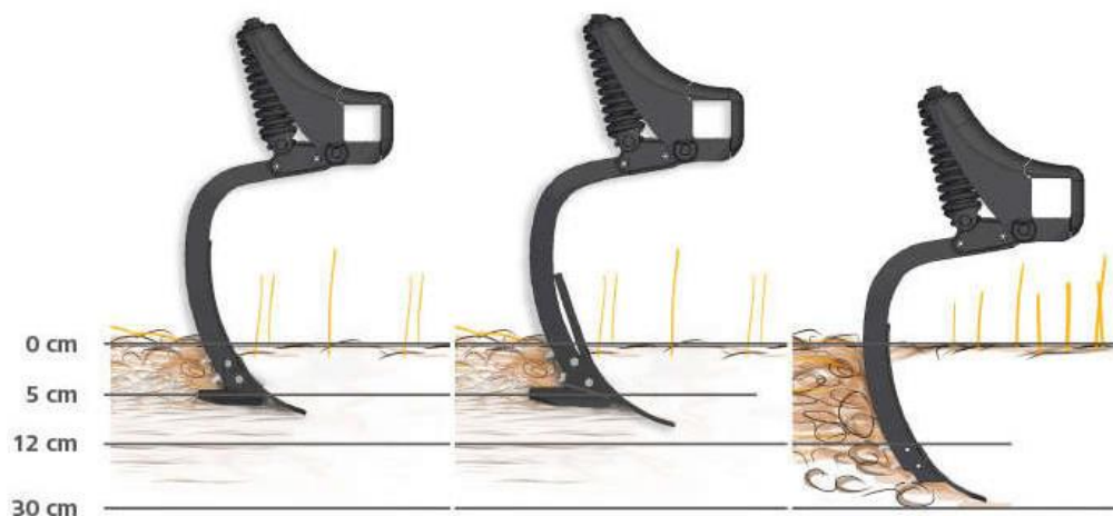
Obrázek 11. Různá hloubka a intenzita zpracování půdy radličkovým kypřičem HORSCH Terrano v závislosti na tvaru radliček
