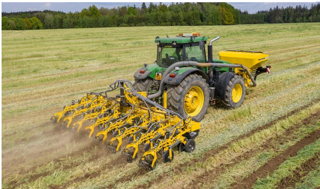
Obrázek 14. Bednar STRIP MASTER Spojení stroje pro pásové zpracování půdy se secím strojem
