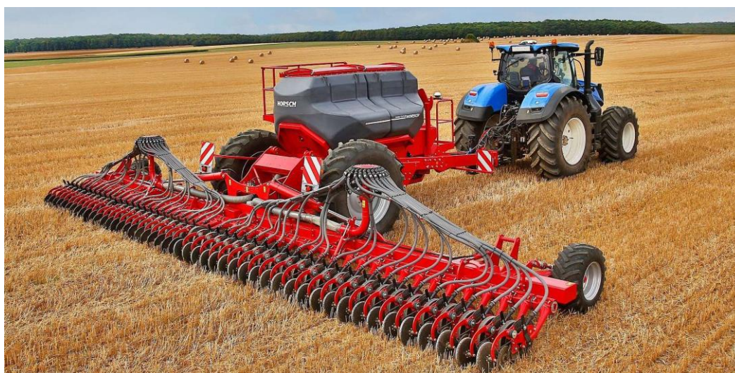
Obrázek 15. Přímé setí do nezpracované půdy secím strojem HROSCH Avatar s kotoučovými botkami
