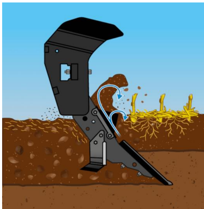
Obrázek 12. Práce hloubkového kypřiče Bednar Terraland při nápravném kypření zhutněné půdy
