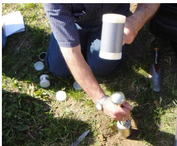
Obrázek 2. Kopeckého metoda odběru vzorků (vlevo), půdní vzorek (vpravo)
