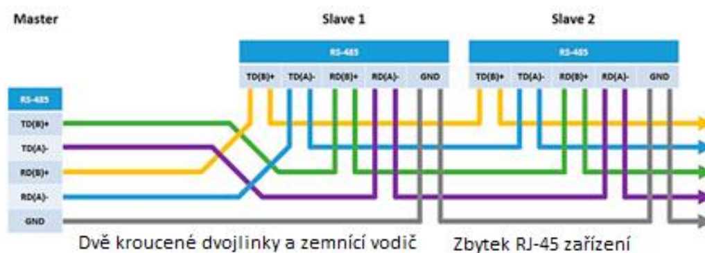
Obrázek 21 - Konfigurace zapojení RS485
