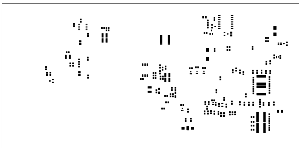
obrázku 76 - Vzor pro nanesení pájecí pasty pro vrstvu BOT
