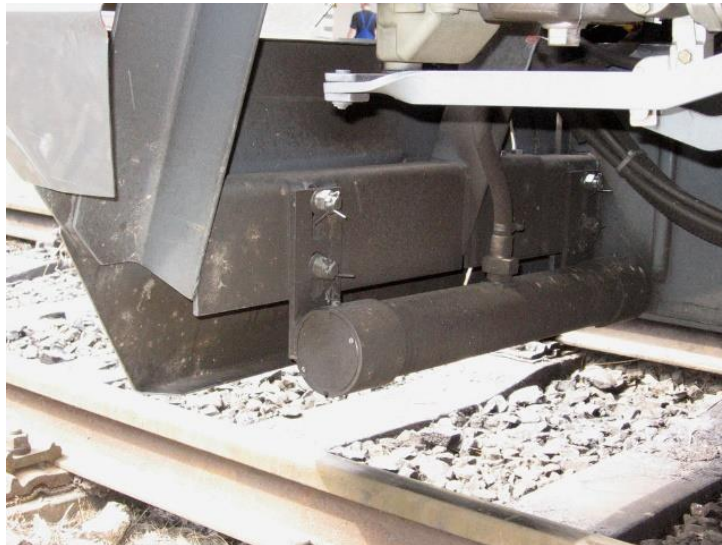
Obrázek 8 - Cívka snímající magnetický signál v kolejnici [5]
