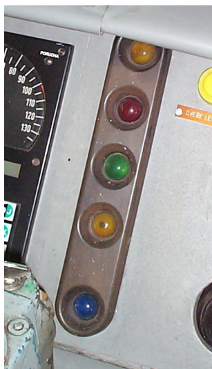
Obrázek 7 - Návěstní opakovač LS II na stanovišti strojvedoucího [5]
