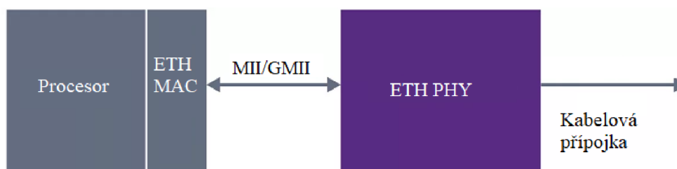
Obrázek 23 - Blokové schéma ethernetové komunikace [27]
