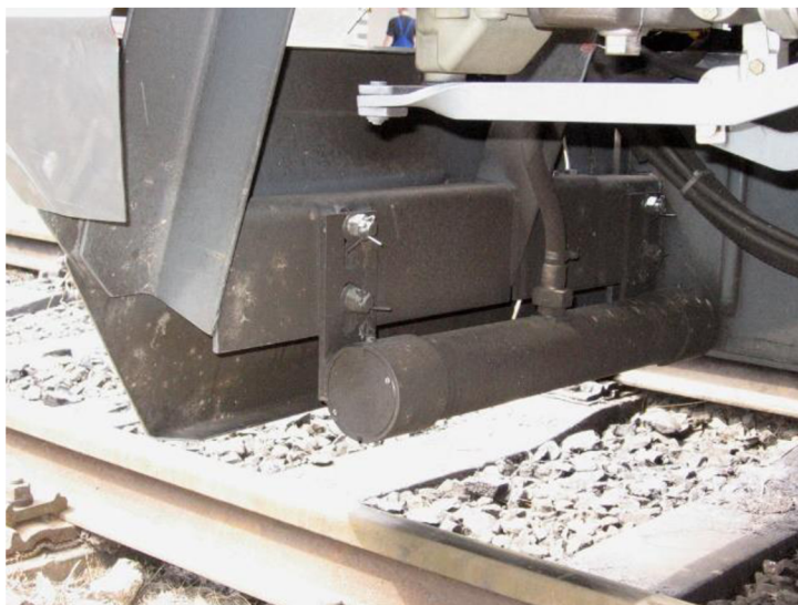
Obrázek 8 - Cívka snímající magnetický signál v kolejnici [5]
