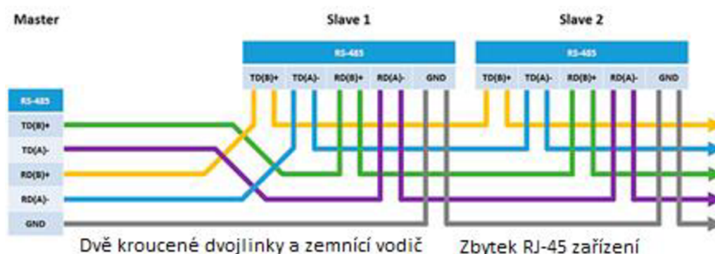
Obrázek 21 - Konfigurace zapojení RS485
