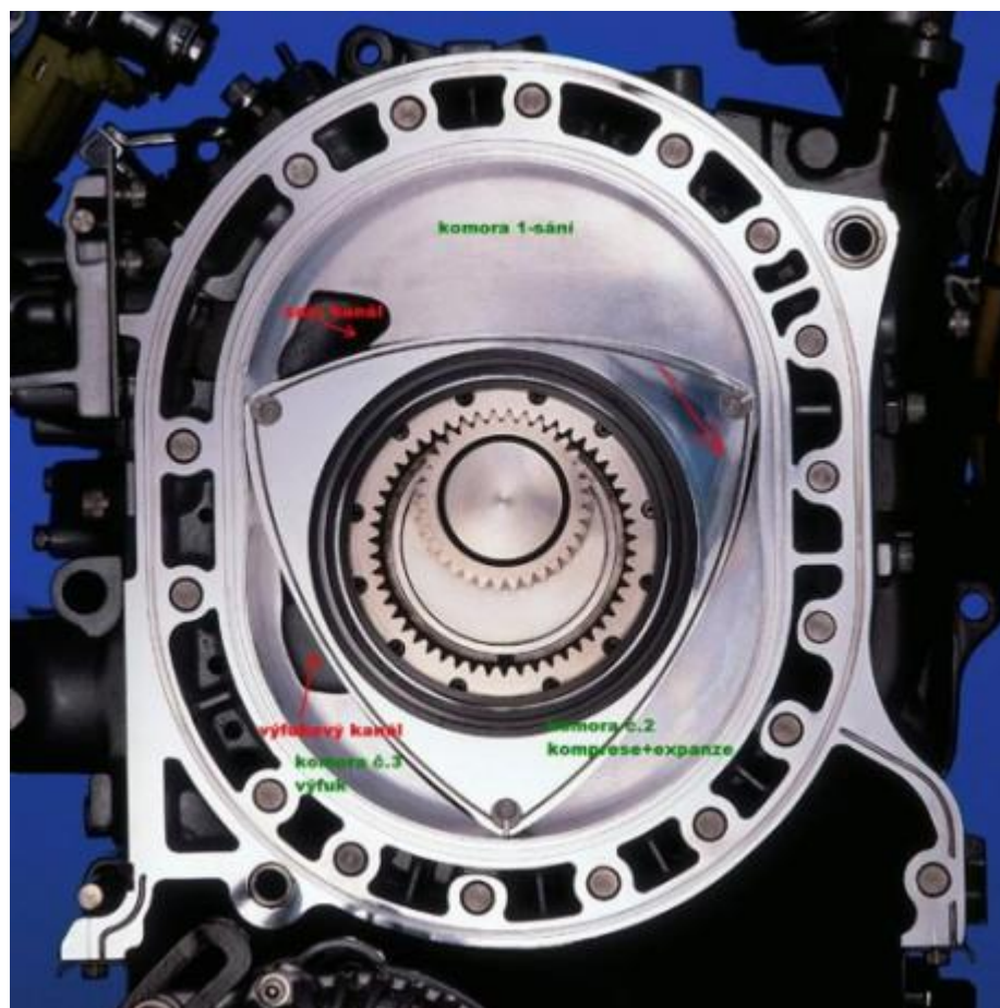
Obr. 1 Wankelův motor Zdroj: vfr800.mysteria.cz
