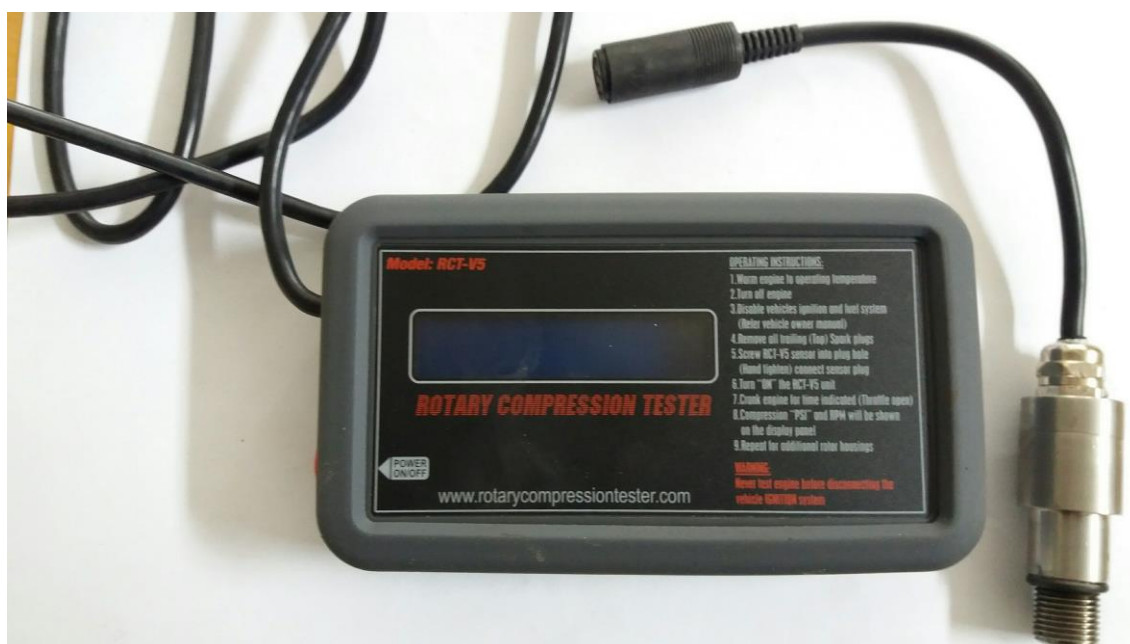
Obr. 2 Kompresiometr RCT V5 Zdroj: vlastní fotografie
