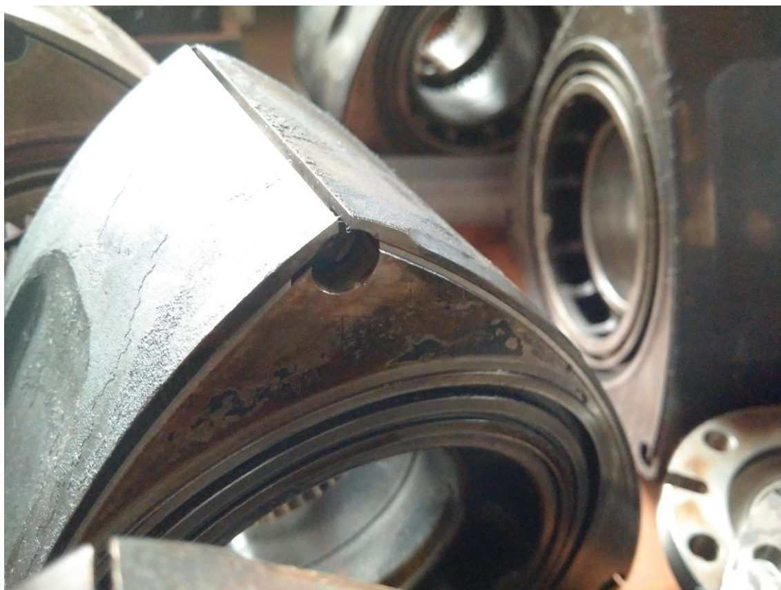
Obr. 12 Píst motoru, zřetelná karbonizace
