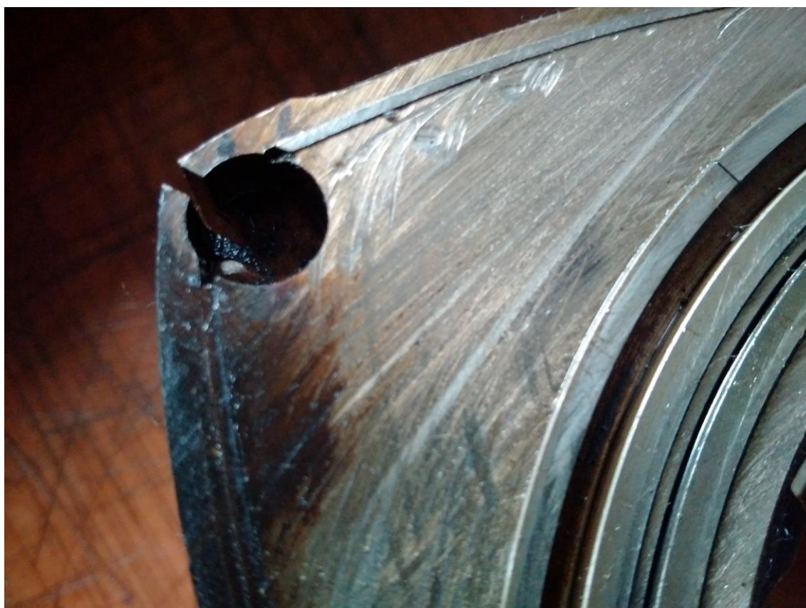
Obr. 9 Poškození uložení těsnící lišty a boční hrany pístu
