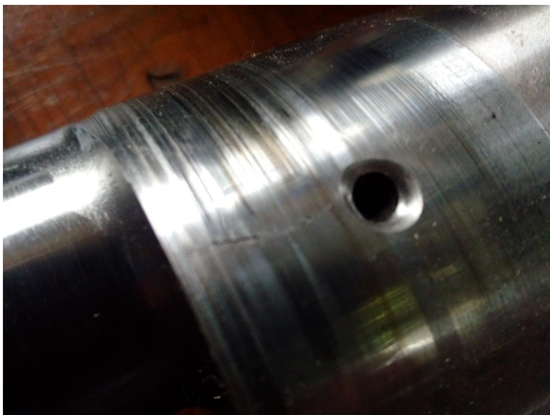
Obr. 10 Kliková hřídel. Poškození uložení klikové hřídele
