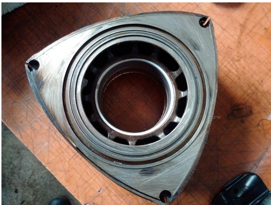
Obr. 8 Viditelné poškození hrany pístu
