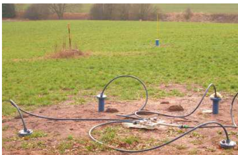
Obr. 4: Aplikační a monitorovací vrtý v terénu
