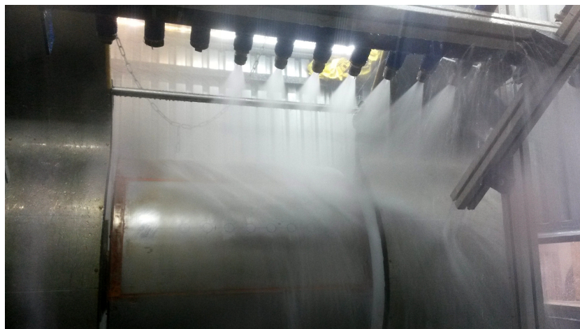
Obr. 6.2: Průběh experimentu ve fázi chlazení ocelového segmentu.
