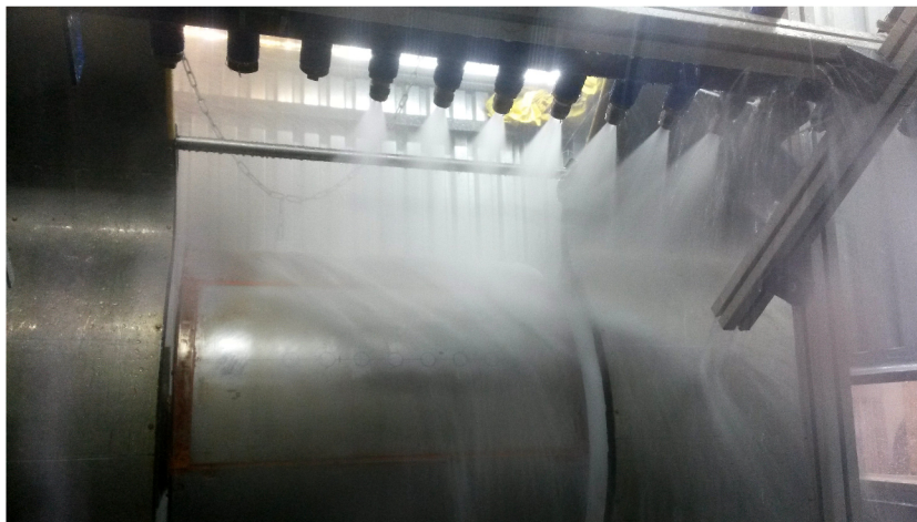
Obr. 6.2: Průběh experimentu ve fázi chlazení ocelového segmentu.
