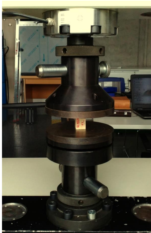
Obrázek 8: Těleso pro zkoušku tlaku v čelistech zkušebního stroje
