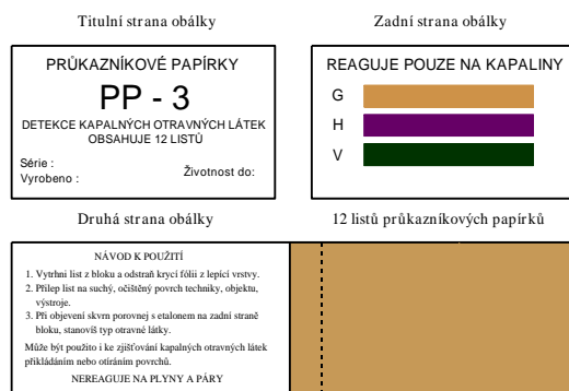
Obrázek 4: Schéma průkazníkových papírků PP-3
