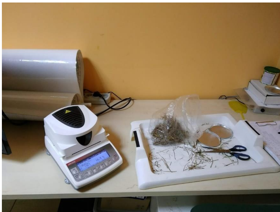
Obr. 26: Měření vlhkosti paliva pomocí sušící váhy.
