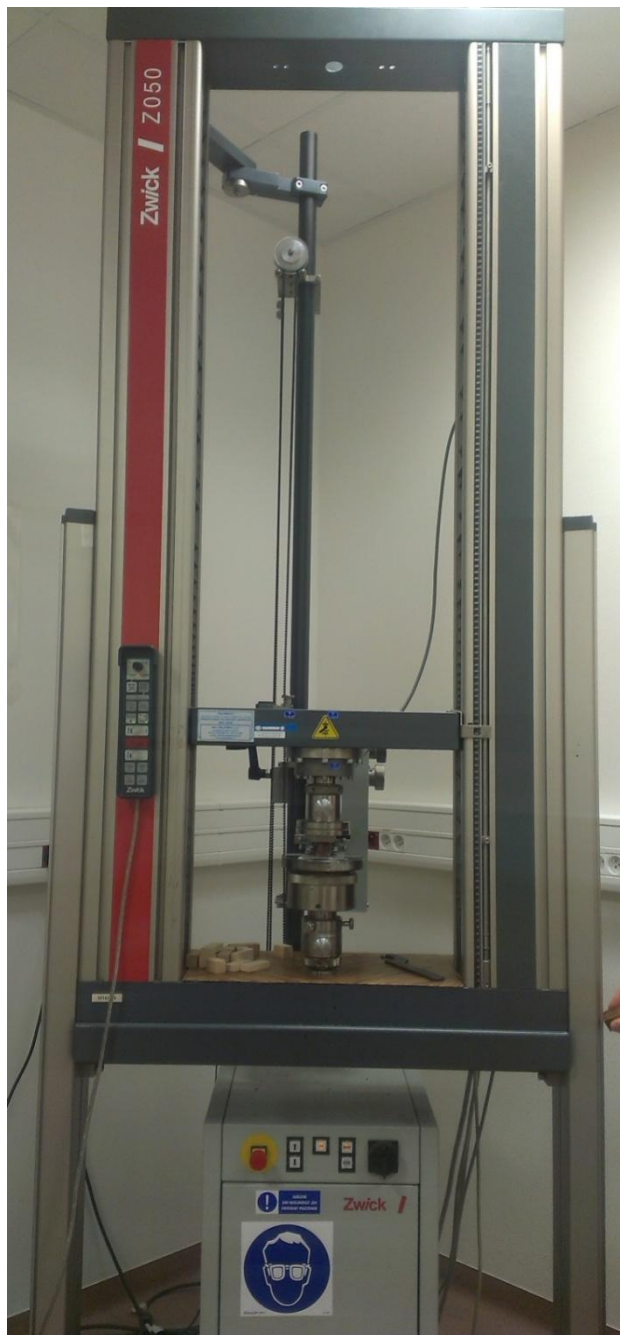
Obrázek 12.: Univerzální zkušební stroj Zwick Z 050
