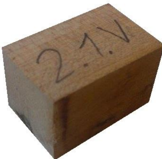
Obrázek 9.: Testovací vzorek pro měření tlaku 20x20x30mm
