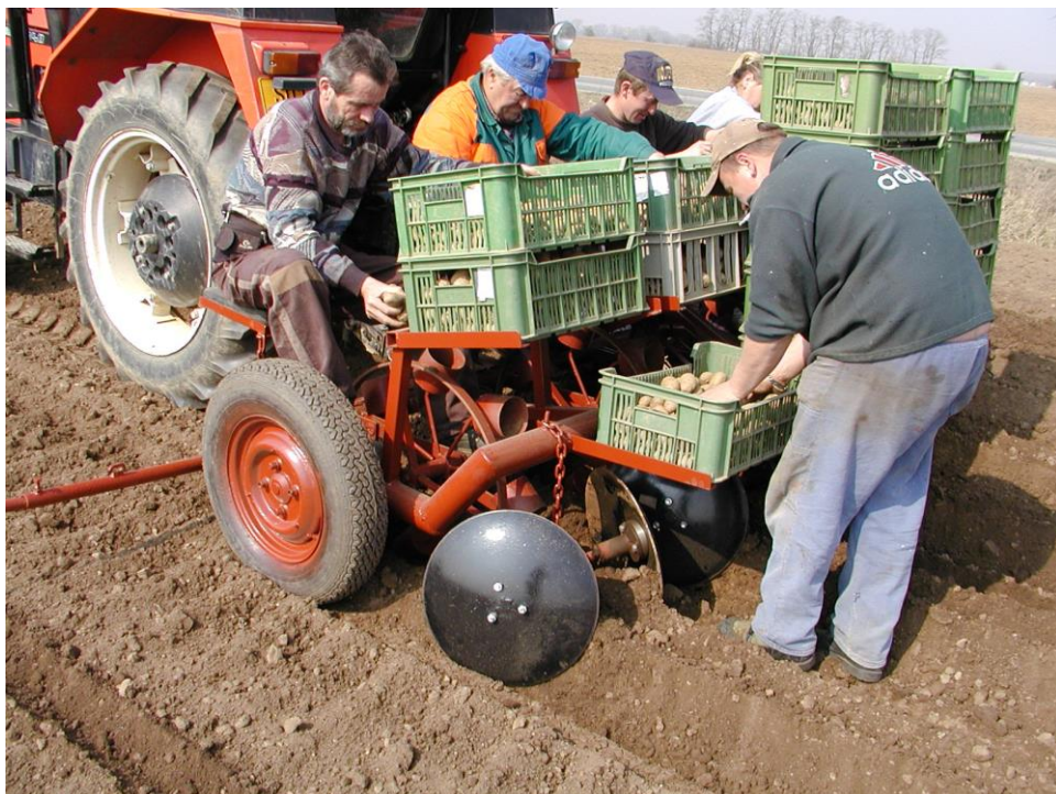
Foto č. 6: Sázení raných brambor poloautomatickými sázeči
