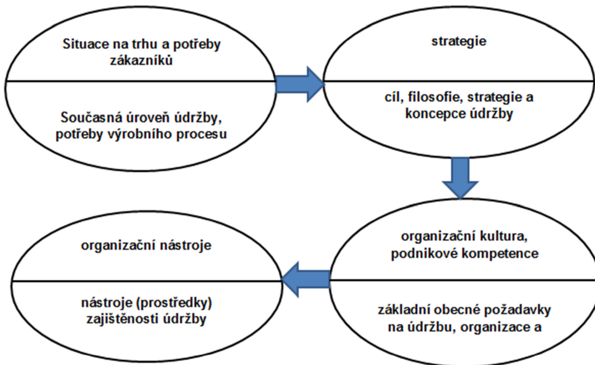
Obr. 2 Základní postup stavby efektivní firmy a údržby [1]
