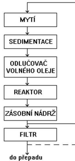
Obr. 6 Schéma uzavřeného okruhu vody na pracovišti pro mytí strojů [4]
