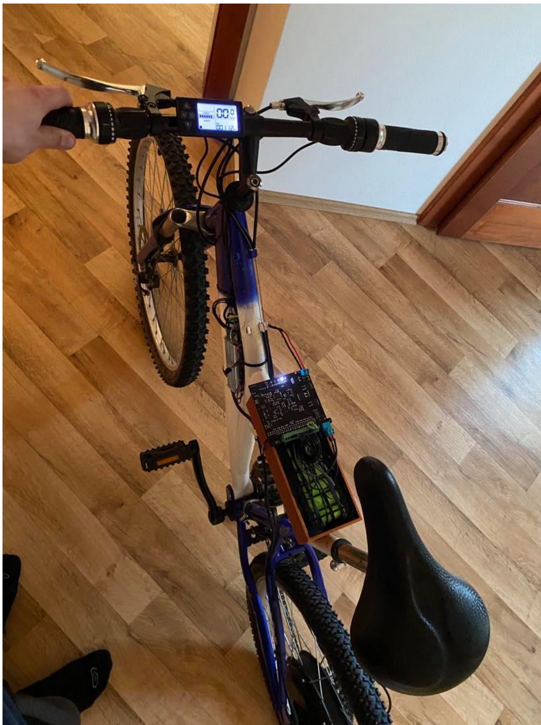
Obrázek 9.5: Elektrokolo s připojenou ZlamBMS
