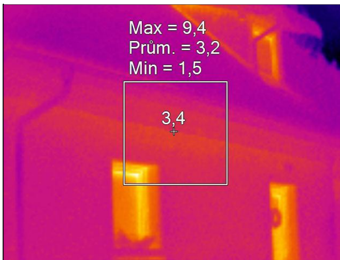
ČÁSTEČNÝ LINEÁRNÍ MOST V MÍSTĚ ZTUŽUJÍCÍHO VĚNCE
