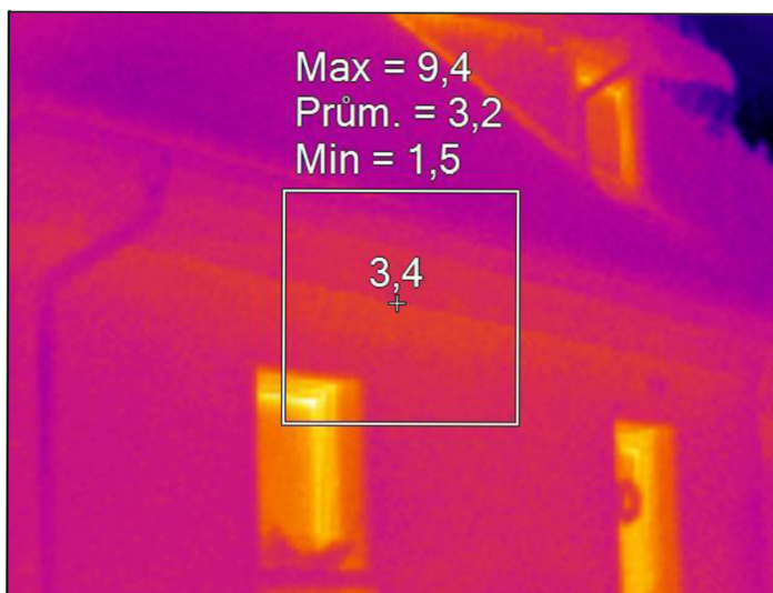
ČÁSTEČNÝ LINEÁRNÍ MOST V MÍSTĚ ZTUŽUJÍCÍHO VĚNCE
