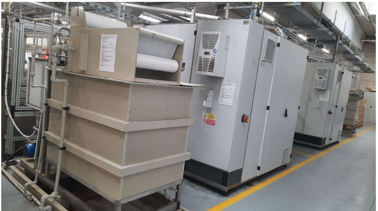
Příloha č. 4 Membránová ultrafiltrace s oplachovacím zařízením ATOLL (zdroj: vlastní)
