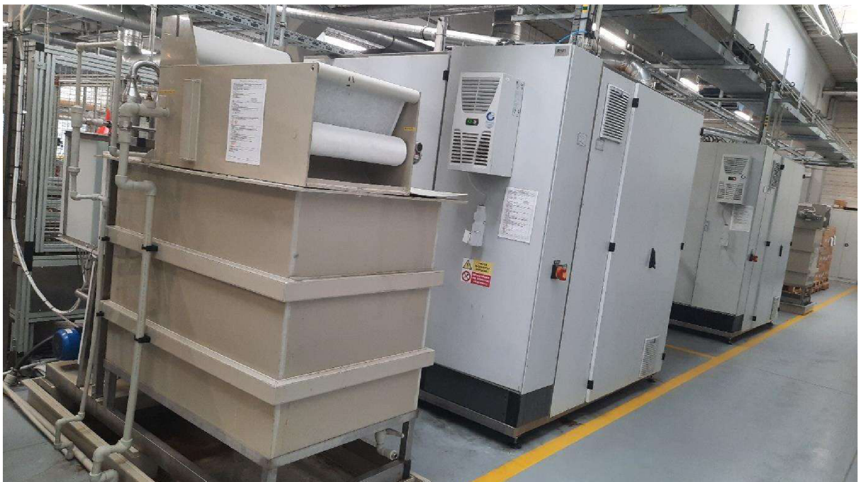
Příloha č. 4 Membránová ultrafiltrace s oplachovým zařízením ATOLL (zdroj: vlastní)
